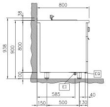
Electrical inlet (power) EQ **Equipotential screw**
